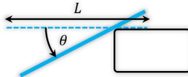
Sebuah batang tipis homogen bermassa  $M$  diletakkan horizontal di ujung meja sehingga seperempat panjang batang terletak di atas meja. Batang kemudian dilepaskan tanpa kecepatan awal sehingga mulai berotasi terhadap tepi meja. Pada sudut  $\theta$  berapakah batang mulai slip terhadap meja? Diketahui koefisien gesek statik antara batang dengan meja adalah  $\mu$ . **(Binovatif)**
