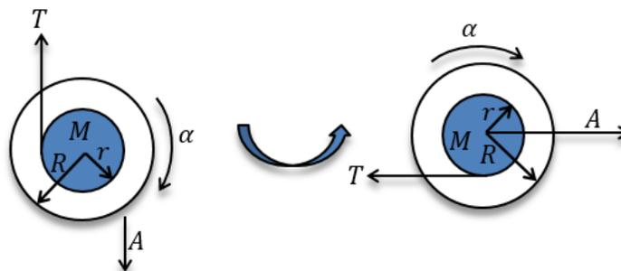
Coba lihat bagian yoyo yang warna hijau, dia kan ibaratkan silinder yang menggelinding tanpa slip di atas lantai, kalau di sini bagian dalam yoyo menggelinding tanpa slip di atas tali. Jadi berlakulah syarat gerak tanpa slip yaitu  $A = r\alpha$ .
